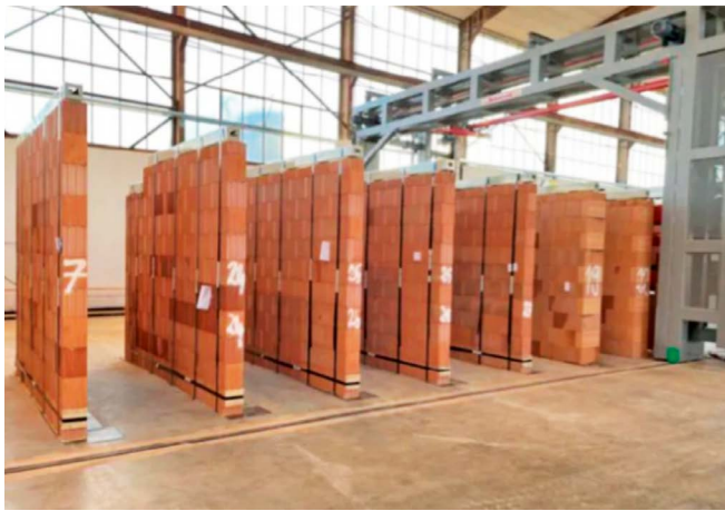
Рис. 4. Стеновые элементы из поризованных керамических блоков [6]
