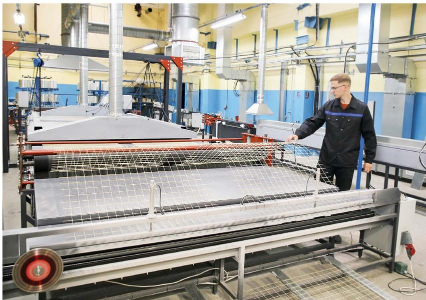
*В открытом акционерном обществе «Полоцк-Стекловолокно» начато производство нового вида продукции – композитной сетки. Она представляет собой изделие из стекловолокна и эпоксидного компаунда (пропитки), полученное методом переплетения скрученных пропитанных нитей с гибкими и прочными стеклопластиковыми стержнями диаметром от 2 до 6 мм с последующей термообработкой.*
