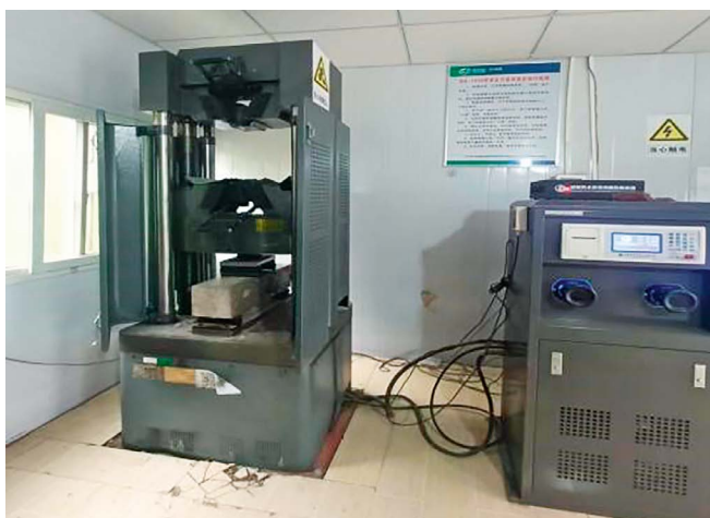
Рис. 5а. Образец на изгиб
