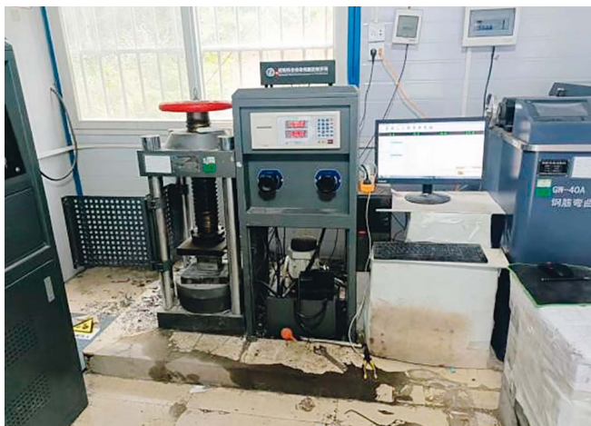
Рис. 6а. Испытание образца на сжатие
