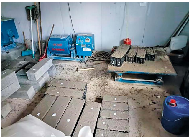
Рис. 4а. Изготовление бетонных образцов
