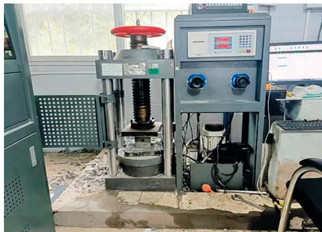
Рис. 6б. Испытание образца на сжатие
