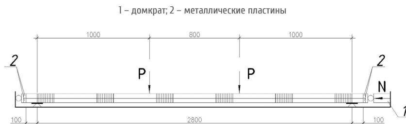
Рис. 6. Общая схема испытаний деревянной конструкции с «УВ-обоймой»: а – приложение поперечной нагрузки; б – приложение продольной и поперечной нагрузок
